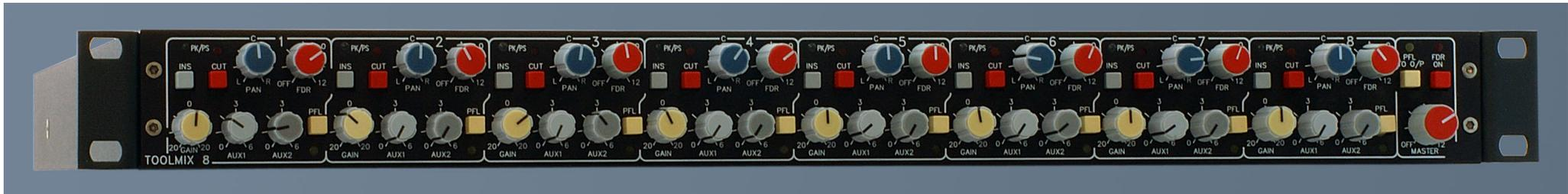
Die 8 Eingänge des Gerätes sind identisch ausgeführt. Der Eingang ist elektronisch symmetriert und kann Eingangspegel von mehr als + 30 dBu verarbeiten. Die Eingangsverstärkung kann durch einen Regler mit kalibrierter Mittenrast um +/- 20 dB geregelt werden. Der Ausgang dieses Verstärkers steht am elektronisch symmetrierten Insert Ausgang zur Verfügung. Die Insert Taste schaltet den ebenfalls elektronisch symmetrierten Einschleifeingang in den Signalweg ein.
