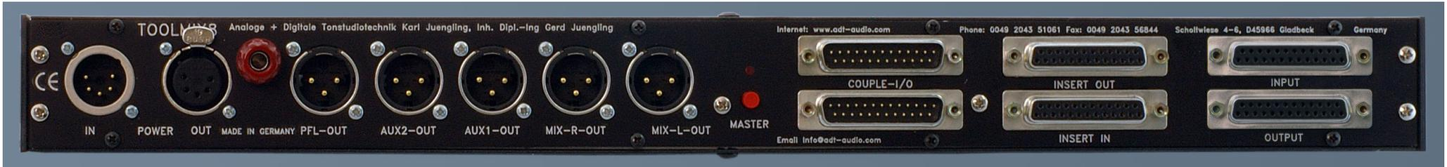
Die Summenausgänge des ToolMix8 liegen auf separaten XLR Einbausteckern auf. Das Gerät verfügt über die Standard-Stromversorgungsanschlüsse und die beiden COUPLE Stecker. Die Belegungen dieser Steckverbinder sind im Anfang dieses Kapitels beschrieben.
