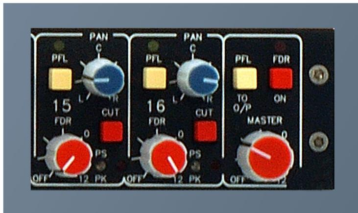
Bei Betrieb des ToolMix32 als Slave erfüllt der Master Regler die Funktion eines Subgruppen Reglers für die Kanäle des jeweiligen Gerätes, da er vor dem Abzweig auf die Koppelschiene eingeschaltet wird.
