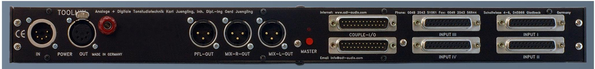
Die Summenausgänge des ToolMix32, Mix L, Mix R und PFL liegen auf separaten XLR Einbausteckern auf. Das Gerät verfügt über die Standard-Stromversorgungsanschlüsse und die beiden COUPLE Stecker. Die Belegungen dieser Steckverbinder sind im Anfang dieses Kapitels beschrieben.
