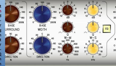
Bänder sind jeweils vollparametrisch ausgeführt. Die Stellbereiche für die Frequenz reichen von 30 Hz bis 1 kHz für die Low-EQ's und 1 kHz bis 20 kHz für die Hi-EQ's. Die Güte lässt sich im Bereich 0.5 bis 3 regeln. Für die Pegelveränderung ist an dieser Stelle ein Regelbereich von ± 12 dB mehr als ausreichend. Die EQ's können einzeln im Breiten-Richtungsmischer und im Tiefen-Richtungsmischer zugeschaltet werden.
