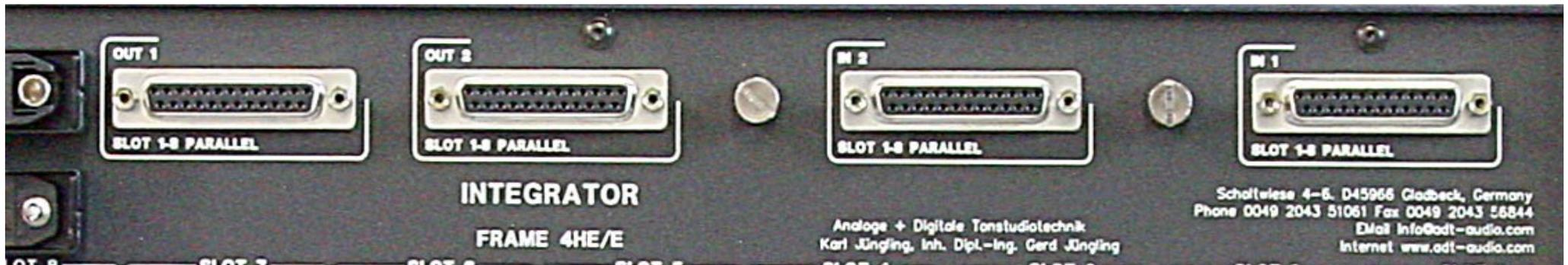
Diese Steckverbindungen sind nur in den 19-Zoll Ausführungen der Träger 4HE/S und 4HE/E eingebaut. Hier liegen die XLR Anschlüsse IN1, IN2, OUT1 und OUT2 parallel auf 25poligen D-Sub Buchsen in ‚Tascam‘ Standard Belegung auf. Für Träger, bei denen 8 Bearbeitungsgeräte eingebaut erleichtert dies den Anschluss zwischen den Träger und zu externen Geräten. Hier sind die Belegungen dieser 4 Steckverbinder:
