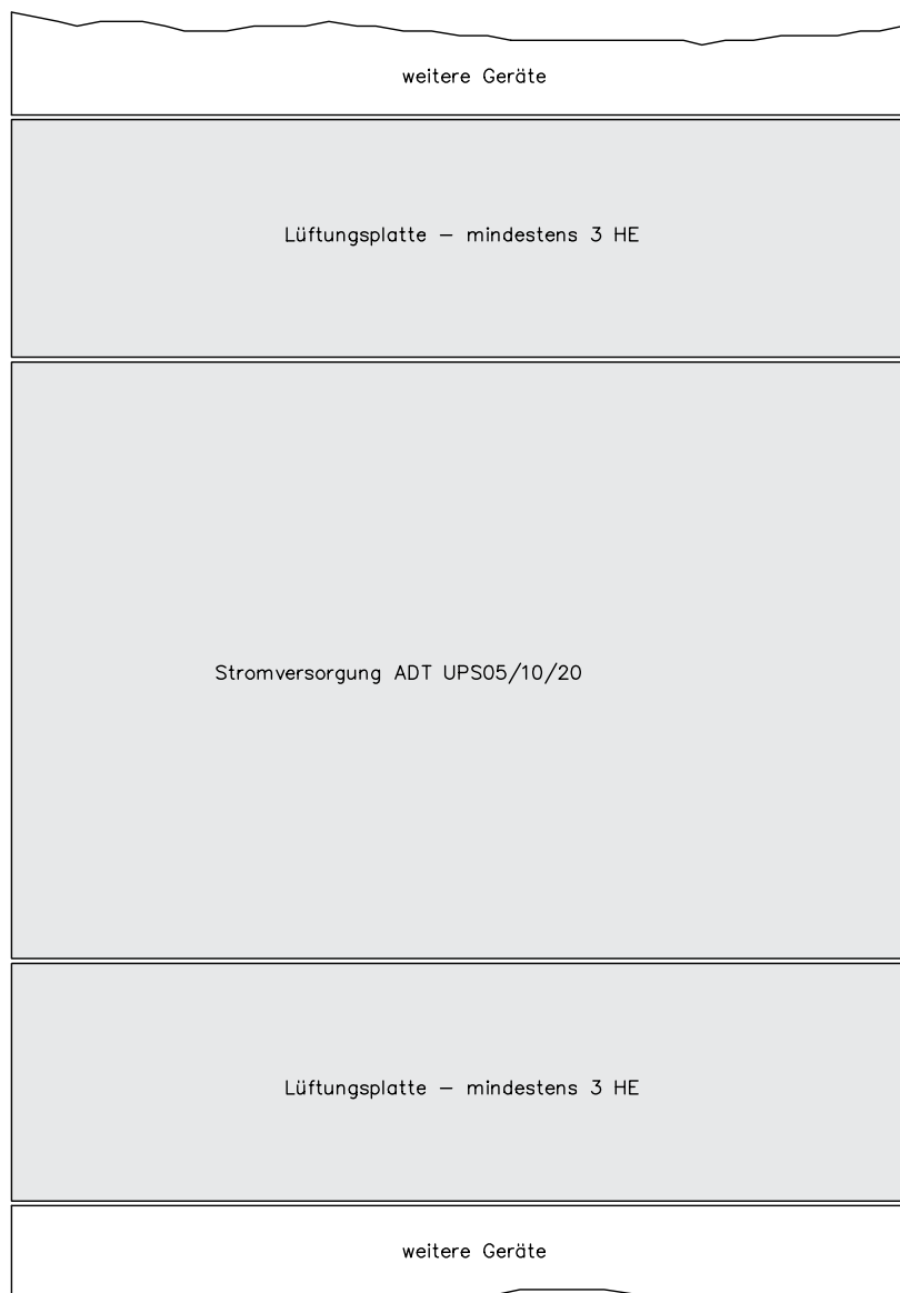
Abb. A1.4 Einbau des Netzgerätes in ein Rack
